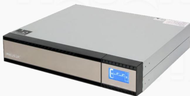
La **Serie Online Rack** con microprocesador y Doble Conversión Real, garantiza una señal estable y limpia a todos los equipos conectados.
